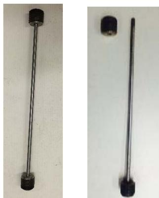
a) Before test      b) Broken
