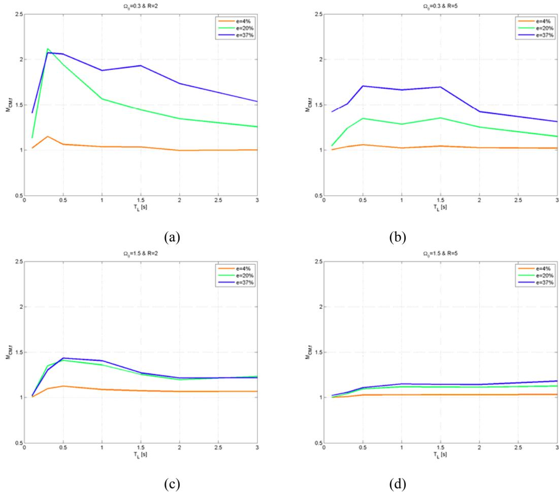
Fig. 9 –  $M_{CM,f}$  spectra for: (a)  $\Omega_\theta=0.3$ ,  $R=2$ ; (b)  $\Omega_\theta=0.3$ ,  $R=5$ ; (c)  $\Omega_\theta=1.5$ ,  $R=2$ ; (d)  $\Omega_\theta=1.5$  and  $R=5$ .
